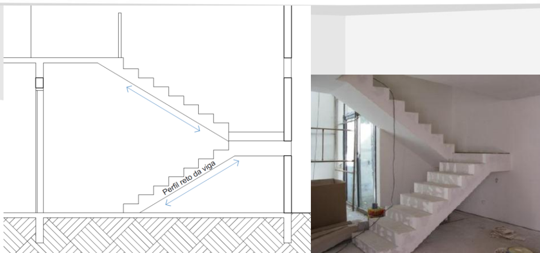
Figura 14: Perfil estrutura de escada em LSF.
