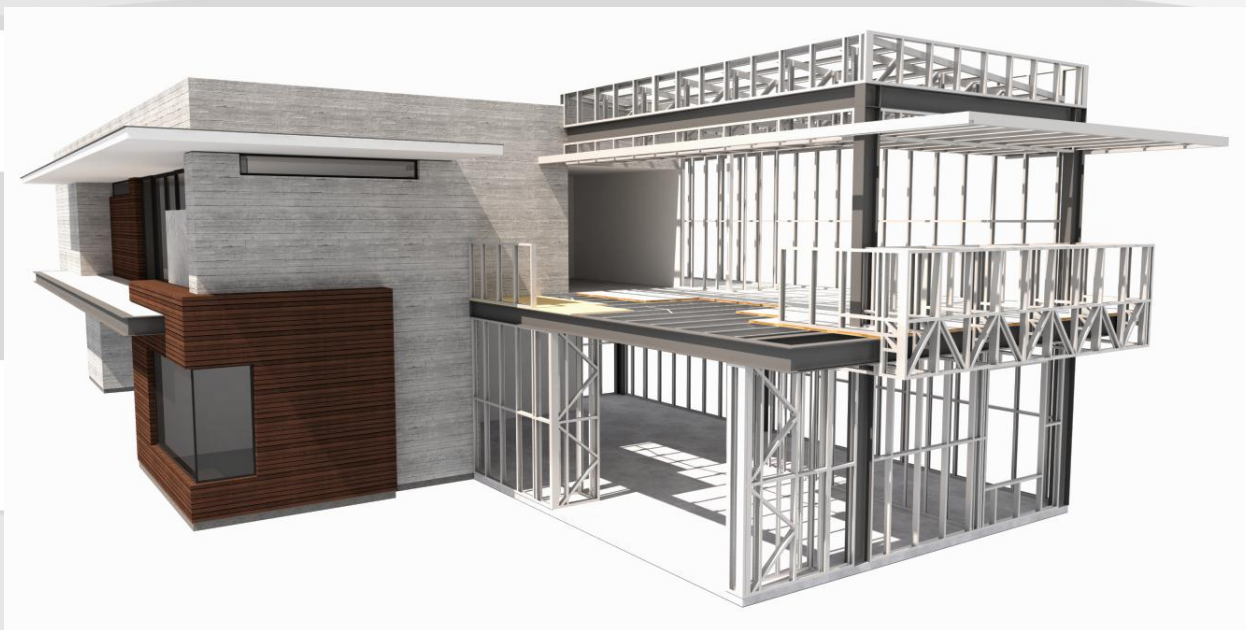
Figura 1: Estrutura em Light Steel Framing.
